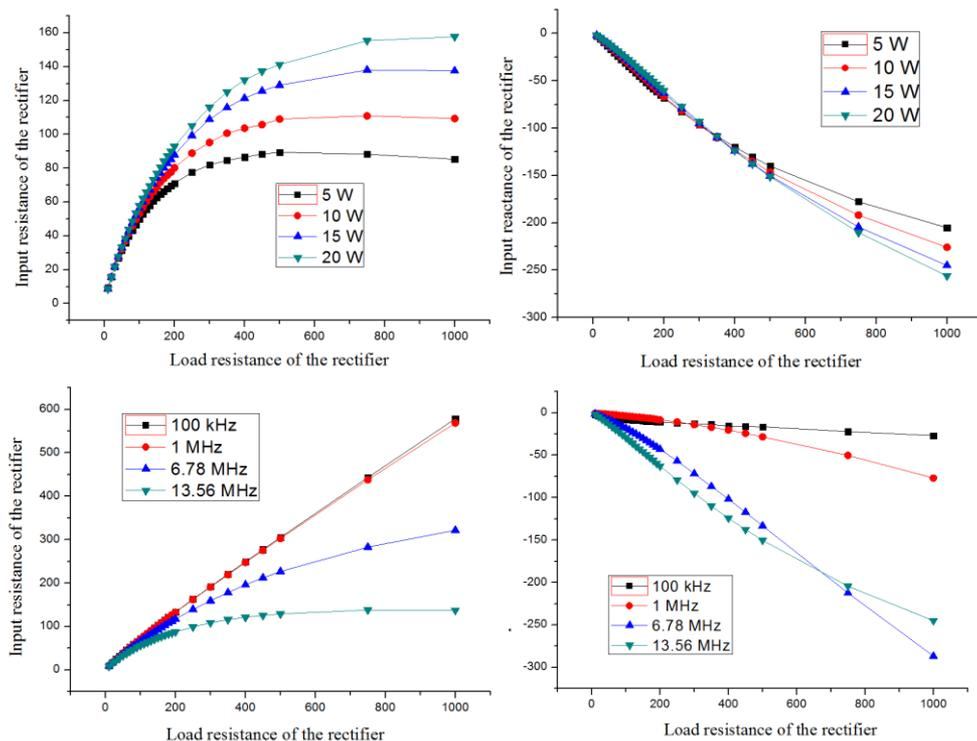
整流器在不同功率和频率下的输入阻抗
